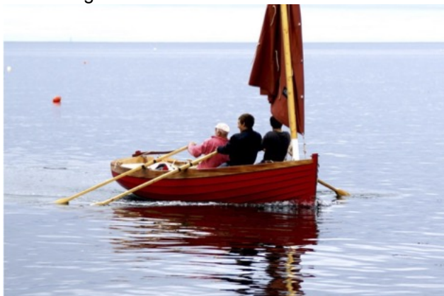
Ilur geklinkert, leichter und angenehm zu rudern
