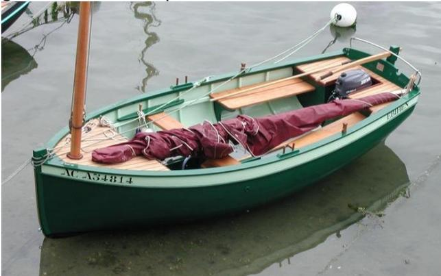
Ein Außenborder wird im Schacht hinter der Pflicht installiert mit dem Gasgriff in Reichweite des Steuermanns. Der Propeller sitzt direkt vor dem Ruder und garantiert gute Manövrierbarkeit. Für die Ebihen 15 / 16 reicht ein Motor mit kurzem Schaft und 3 - 6 PS aus. Das Stahlschwert verbessert die Stabilität und sorgt für gute Kreuzeigenschaften. Es besteht die Auswahl zwischen vielen verschiedenen Takelungen ganz nach Ihren Wünschen bis hin zum Gaffelkutter.
